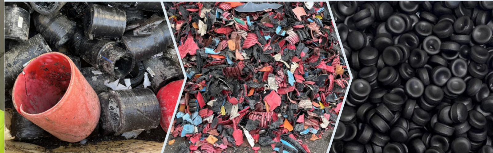
Bildet til venstre: Elisabeth Hovda, Hallingplast og Stian Thorsen, Pipelife. Bildet over: Fra venstre mot høyre: Oceanize fjernet pakninger og elektromuffer på plastrørene. Så ble plastrørene kvernet og vasket. Resultatet ble granulater av meget god kvalitet.
