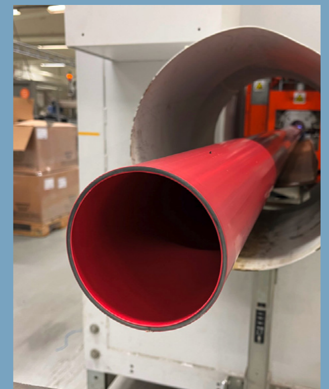
Tre-sjikts kabelrør med et midsjikt med ca 50 prosent resirkulert PVC
