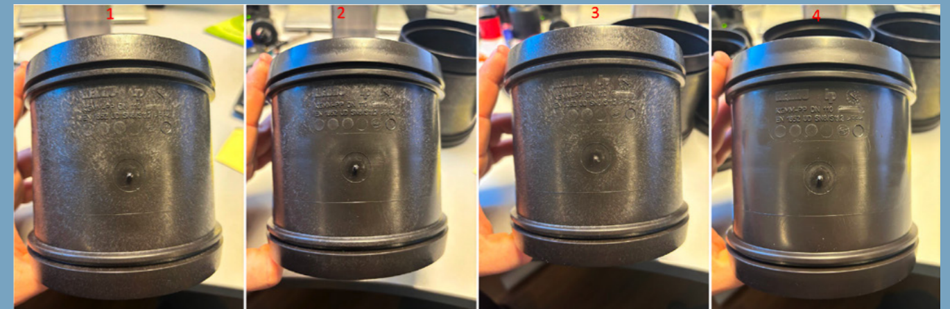
Det ble noe variasjon i overflaten på de sprøytestøpte dobbelmuffene. På grunn av en noe ujevn kvalitet på det resirkulerte materialet, ga det utslag i variasjon i overflaten på delene som ble produsert.
